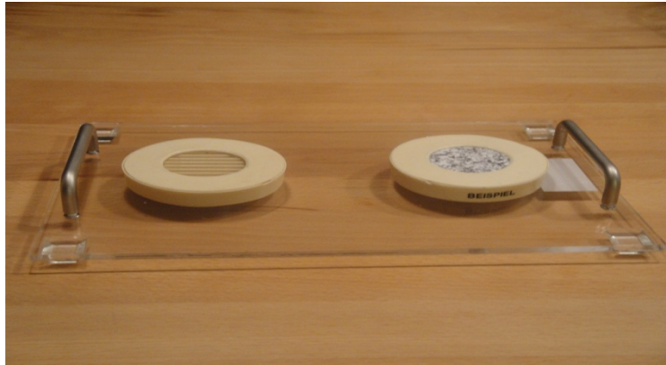
Abbildung 3: Messanordnung des Haptik Schwellen Test, links das fix montierte Referenzpad, rechts das drehbare, austauschbare Schwellenpad
