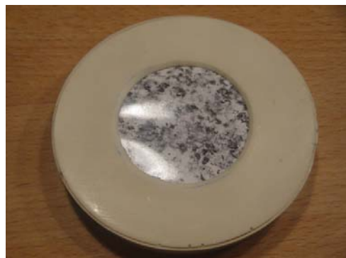
Abbildung 16: Pad Nummer 11, Unebenheiten in der Trennfolie erkennbar
