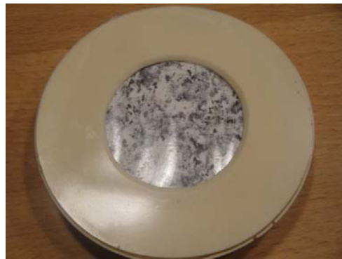
Abbildung 15: Pad Nummer 9, Unebenheiten in der Trennfolie erkennbar
