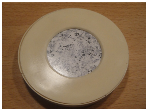
Abbildung 17: Pad Nummer 12 zum Vergleich, keine Unebenheiten erkennbar
