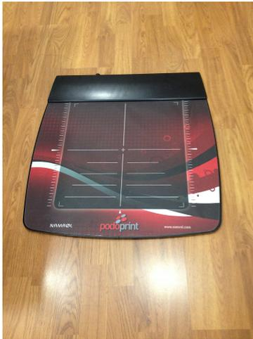
Anexo 2: Plataforma de presiones de la marca Namrol, modelo WGP40PCB.
